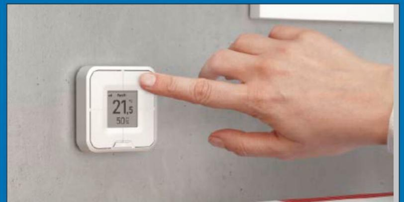
Die Fritz-DECT-Taster lassen sich beliebig platzieren oder mit dem mitgelieferten Klebestreifen an einer Wand anbringen und wie ein konventioneller Schalter nutzen. Der Fritz-DECT 440 besitzt ein E-Paper-Display und bietet flexible Schaltmöglichkeiten für die Fritz-DECT-Produkte. Zudem dient der Fritz-DECT 440 als externer Temperatursensor für die Heizungsregler Fritz-DECT 301/302.
