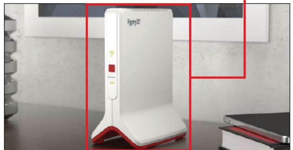
**4** Die weitere Einrichtung erfolgt wie bei der Fritzbox über die Konfigurationsmaske. Nutzen Sie nur einen AVM-Repeater, öffnen Sie den Browser, tippen die Adresse „fritz.repeater“ ein und bestätigen mit der Eingabetaste. Kommen mehrere Zubehörgeräte zum Einsatz, rufen Sie die Konfigurationsmaske des neuen Geräts über dessen IP-Adresse auf. Diese finden Sie über die
