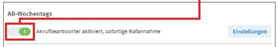
9 Um den Anrufbeantworter abzuhören, nehmen Sie ein Telefon, das per Kabel oder über DECT an der Fritzbox angeschlossen ist. Drücken die Tasten „\*\*600“ sowie Anrufen und folgen den Sprachanweisungen. Praktisch: Damit Sie nicht immer die Fritzbox-Konfigurationsmaske aufrufen müssen, um herauszufinden, ob neue Nachrichten auf dem AB auf Sie warten, macht Sie die Fritzbox durch ein blinkendes Info-Lämpchen darauf aufmerksam.
