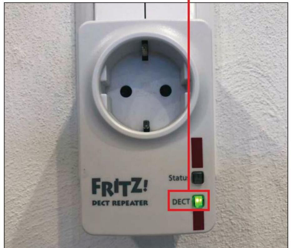
**3** Drücken Sie etwa an der Fritzbox 7590 die Taste „Fon/DECT“ so lange, bis die LED anfängt zu blinken. Fritzbox und Repeater verbinden sich nun automatisch – die „DECT“-LED am DECT-Repeater leuchtet dauerhaft, sobald er einsatzbereit ist. Bei einem aktiven Telefonat leuchtet zusätzlich die Status-LED am DECT-Repeater.
